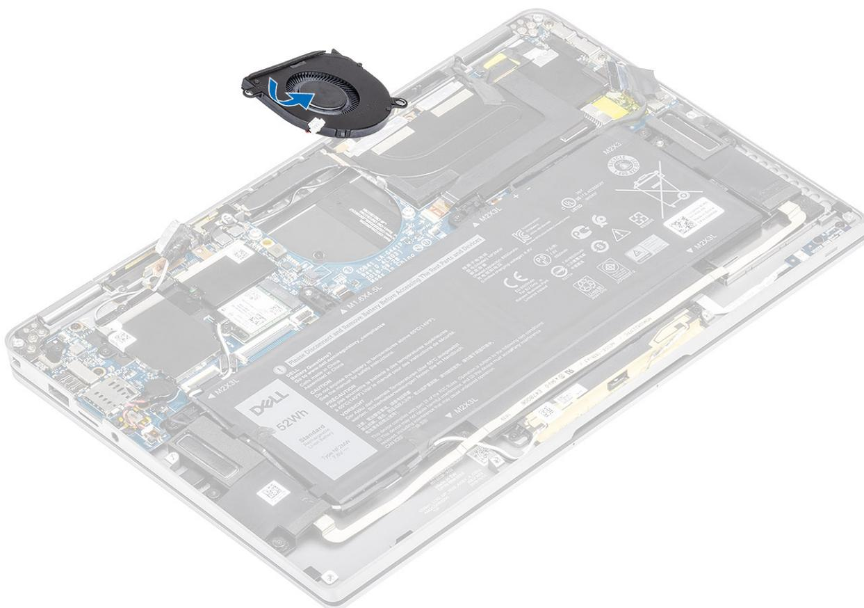
2. Volte a colocar o único parafuso (M2x2) [1] para fixar a ventoinha à placa de sistema.
